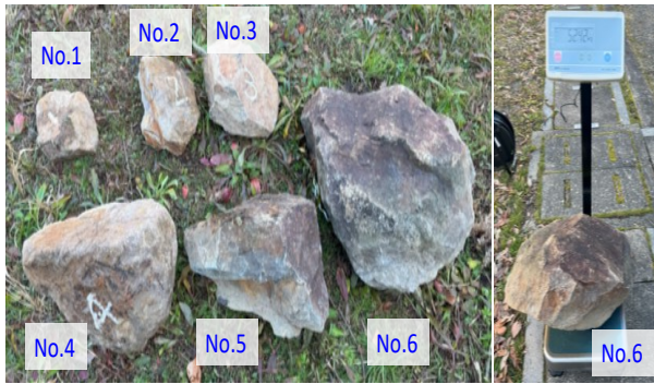
図-5 左：実験に使用した石の外形 右：No.6 計量 (52.42kg)
